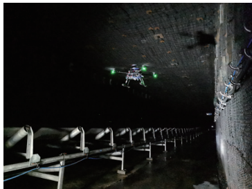
输送带巡检机器人
