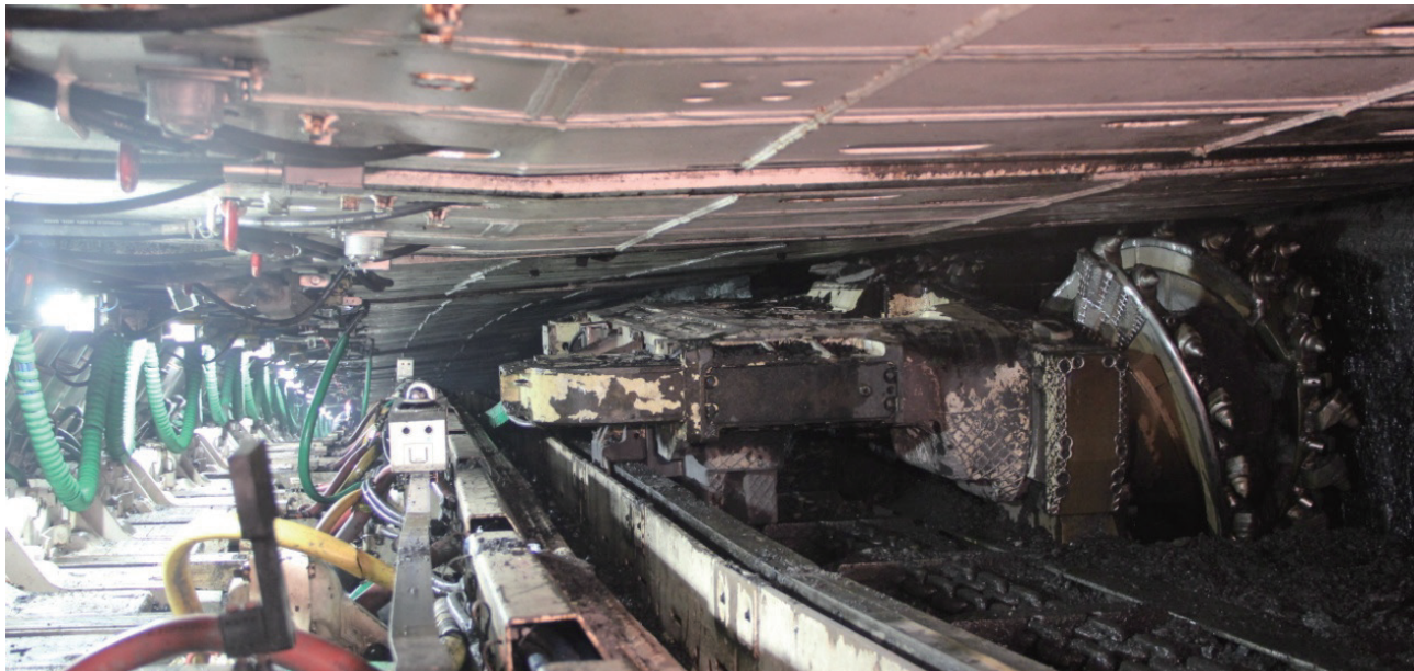
石圪台煤矿薄煤层等高无人智能开采工作面
