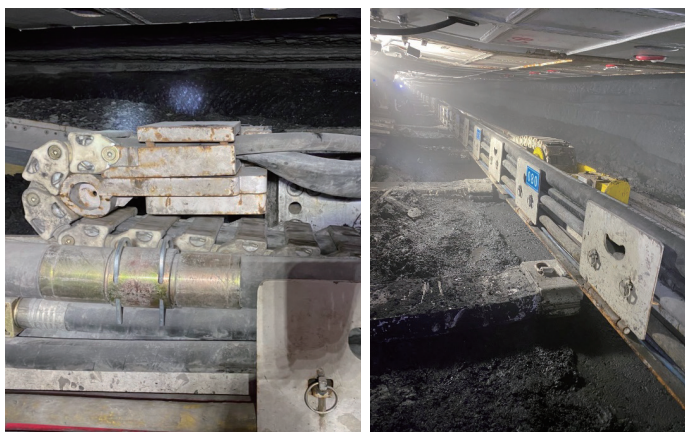
采煤机牛头拖缆小车
