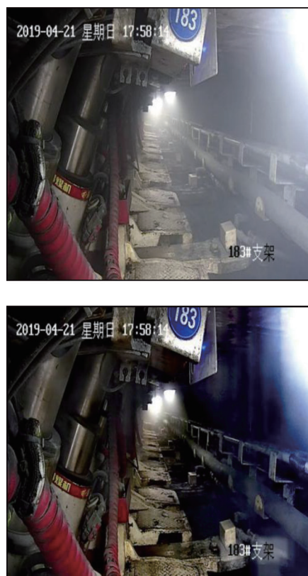
图1 井下视频图像去雾、去噪对比效果
