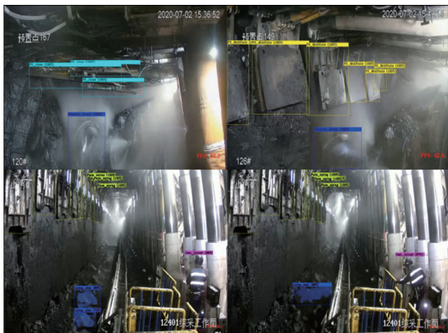
图2 煤矿井下复杂场景关键设备目标检测提取效果
