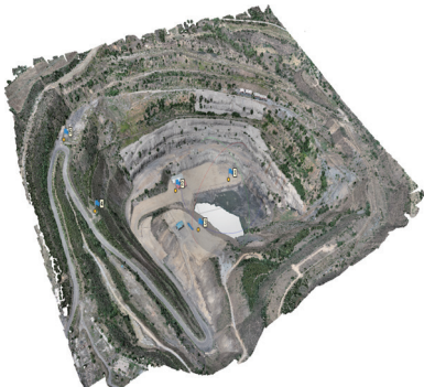
图8 高密度点云(6300万点含控制点)
