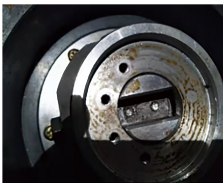
图4 摆角传感器断裂
