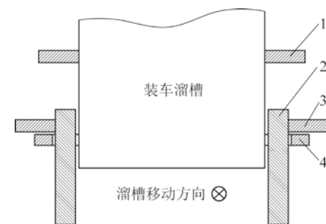
1—活动挡板垂直方向上限位；2—活动挡板； 3—活动挡板垂直方向下限位；4—活动挡板安装槽
