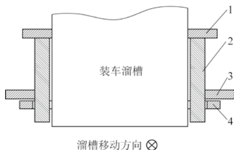
1—活动挡板垂直方向上限位；2—活动挡板； 3—活动挡板垂直方向下限位；4—活动挡板安装槽
