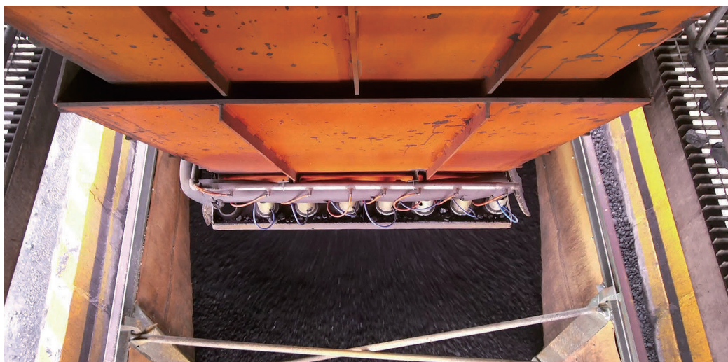
图2 装车站伸缩溜槽
