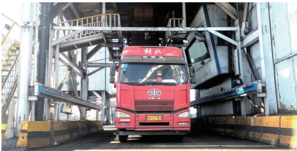
图1 车厢规格检测应用实拍（蓝色为信标定位装置）
