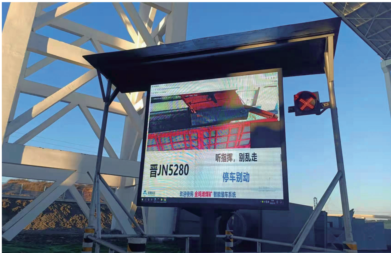
图3 智能汽车快速定量装车LED指挥引导大屏及红绿灯指挥系统
