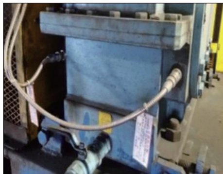
(b) 大型减速器温度震动有线传感器安装位置图
