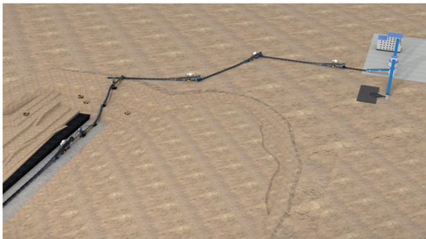
采用大倾角带式输送机的煤炭连续运输系统效果
