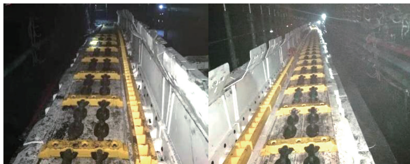
超长工作面刮板输送机井下安装
