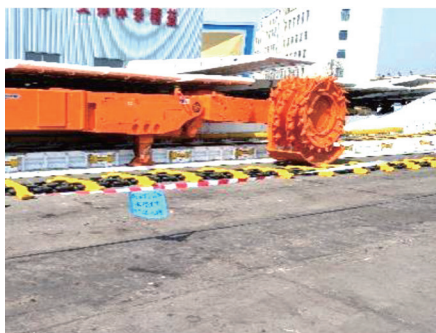
超长工作面刮板输送机与配套采煤机地面联调
