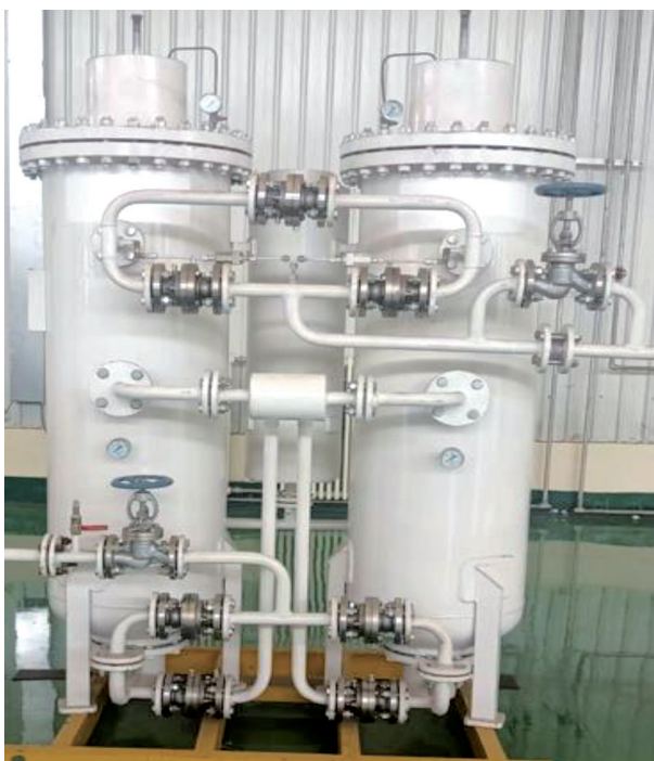
(c) 变压吸附分离段实物
