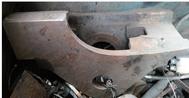
图1 损坏的导向滑靴
