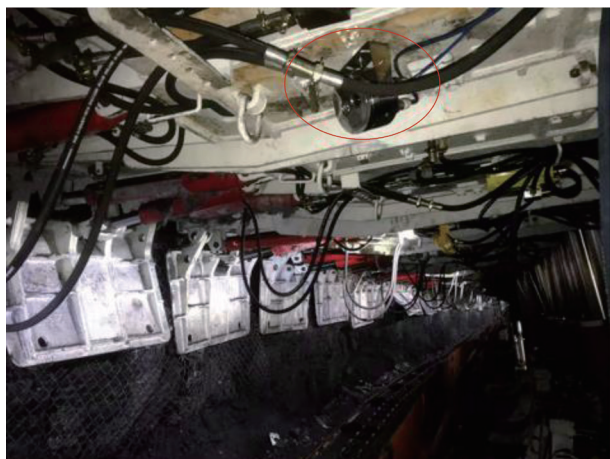
图1 综采工作面视频监控摄像头安装展示
