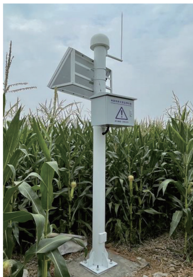
图5 北斗高精度地质沉降监测站
