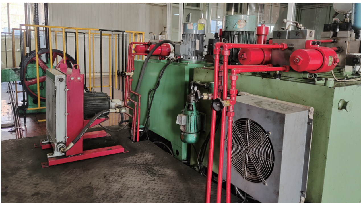
图1 矿井主提升机液压制动系统自动翅片风冷散热装置
