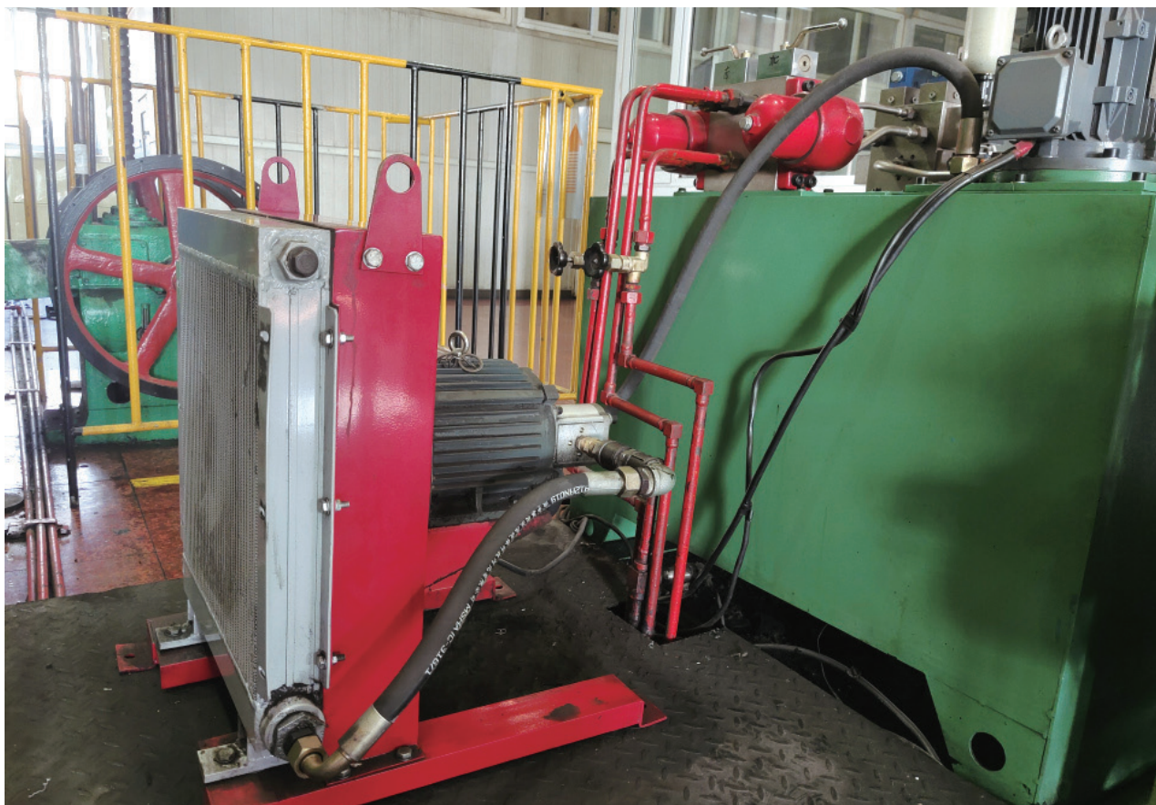
图3 矿井提升机液压制动冷却装置（第二代）
