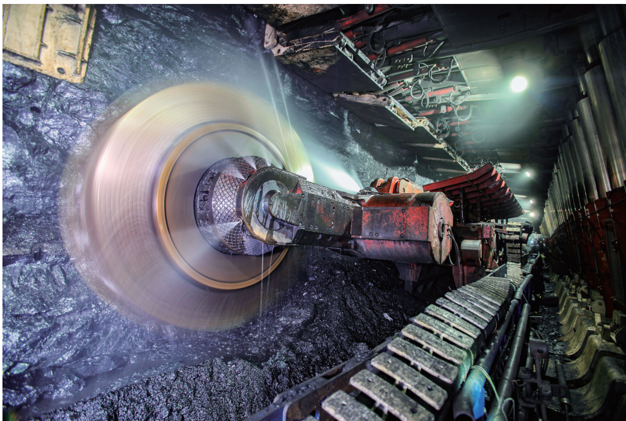
国内第1个千米埋深、灾害严重、条件复杂矿井大采高（6.5 m）智能工作面，日产原煤超万吨
