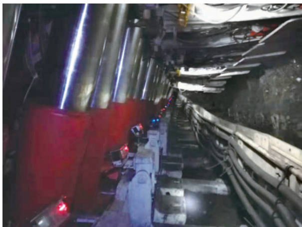
图4 网络型智能控制平台在新元31004工作面应用
