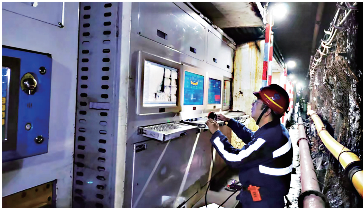
图1 20101智能综采工作面集控系统测试
