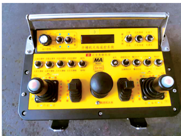
图5 开槽机无线遥控系统控制手柄
