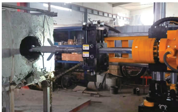
图6 液压芯杆机械扩孔装置模拟扩孔试验
