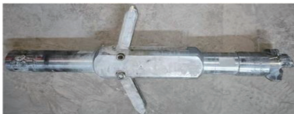
图2 芯杆顶进式机械扩孔器
