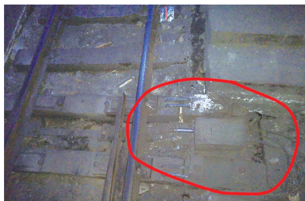
图1 传统边置气缸式气动道岔
