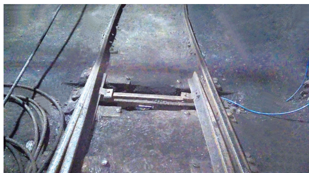
图4 中置气缸式气动道岔机现场应用
