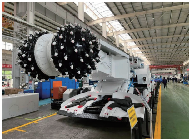
图2 横轴式掘进机
