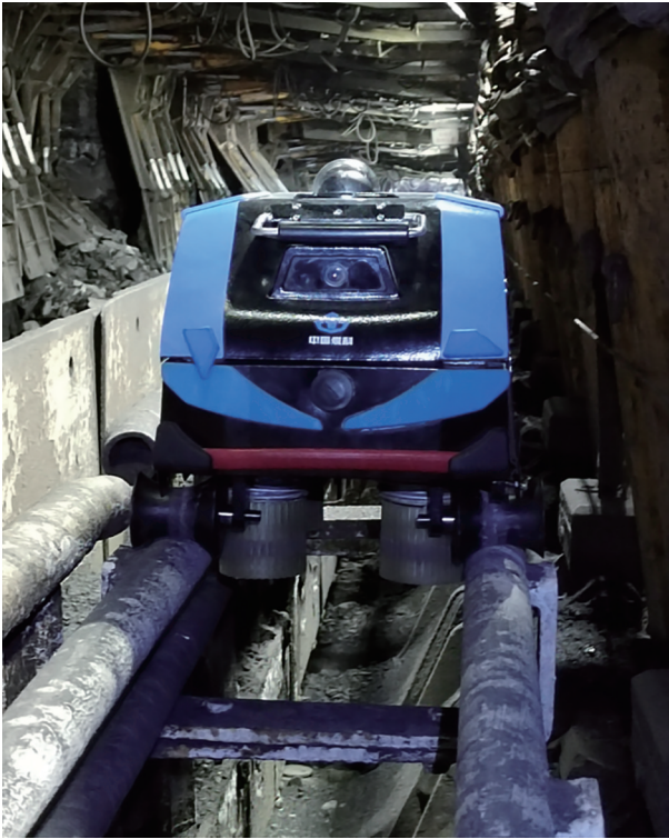
图 12 视频巡检机器人工作面应用
