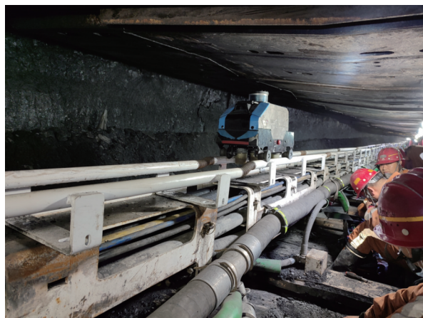
(a) 三维扫描机器人工作面应用
