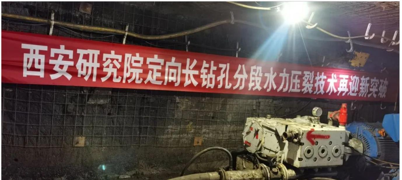
近日,中国煤科西安研究院定向长钻孔分段水力压裂“一孔多用”技术再迎新突破。该技术的创新性突破为彬长矿区减少冲击地压、高瓦斯、水、火等灾害影响提供了有效途径。该技术在彬长矿区胡家河矿401106工作面的应用实践中取得了显著效果,目前已顺利回采通过压裂区域,监测数据显示顶板钻孔抽采纯量较传统瓦斯抽采孔提高2-3倍,工作面能量与应力降低幅度达20%-30%,有效降低了冲击风险。现场实践证明,水力压裂技术可实现冲击地压、水及瓦斯的协同防治,在顺煤层钻孔中可达到煤层增透、降尘、提高块煤率等目的,真正实现“一孔多用,降本增效”的目标。
