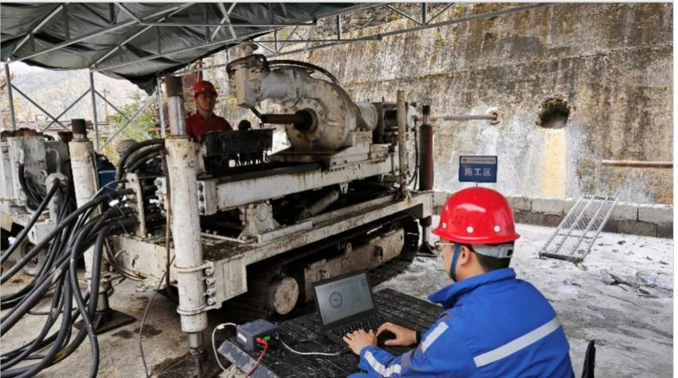
近日,中国煤科西安研究院在惯性导航技术应用方面取得重大突破,成功自主研制出两款基于惯性导航的随钻轨迹测量装置,分别为YSX1-2000矿用光纤陀螺有线随钻测量装置和YSX2-2000矿用MEMS陀螺有线随钻测量装置。这两款装置在柞水试验基地成功进行了现场试验,标志着随钻轨迹测量技术领域迎来了新的突破。
