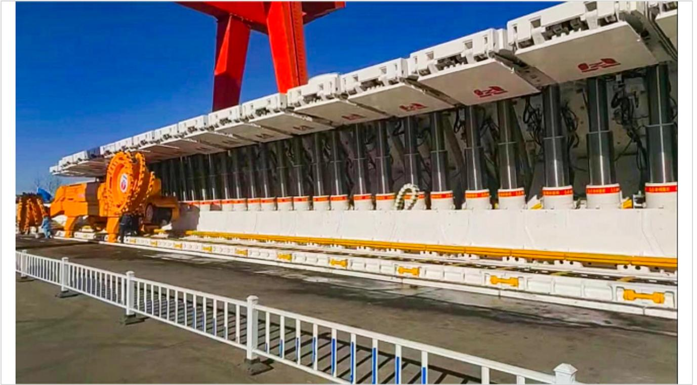
近日，由中国煤科天地奔牛为陕西小保当矿业有限公司研制生产的国内首套装机功率7000kW、年产2000万吨刮板输送装备在小保当矿业成功完成地面联合试运转。
