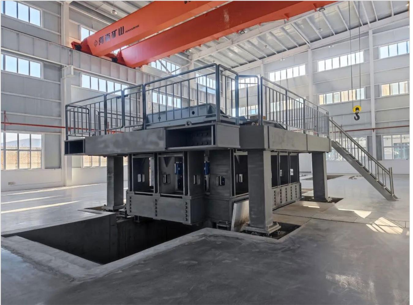
近日,国际首套1:1比例锚杆护表构件试验系统完成首架试验。中国煤科首席科学家、中国工程院院士康红普现场指导锚杆护表构件的力学性能试验,并取得了理想的试验结果。本次试验通过“1:1比例锚杆护表构件试验系统”,在实验室模拟了巷道围岩变形全过程,还原了井下锚杆支护巷道围岩变形破坏特征。
